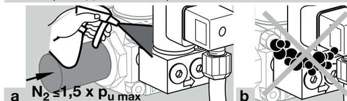
Проверьте герметичность байпасного клапана/газового клапана запальной горелки на входе и выходе.
