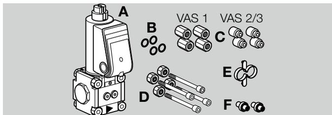
**A** 1 байпасный клапан/газовый клапан запальной горелки VAS 1,
