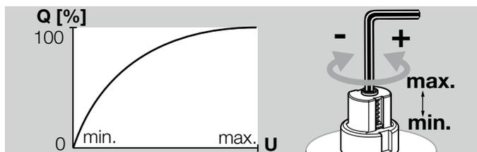
→ При перекручивании регулировочного винта герметичность VAS 1–3 сохраняется.
